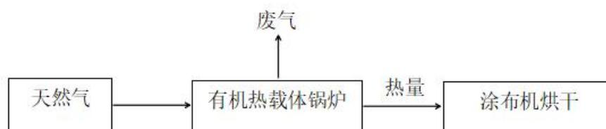
图 3-2 涂布机改造后的生产工艺流程
